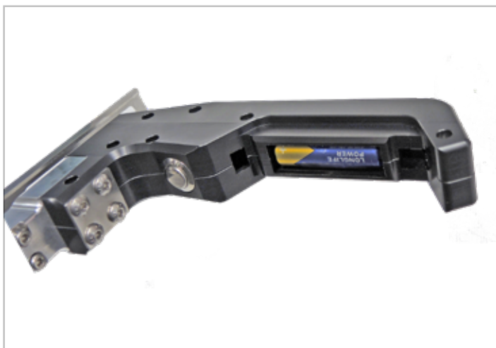
3. Die alte AA-Batterie entnehmen. Eine neue 1,5V-AA-Batterie einlegen. Achtung! Die richtige Polarität beachten.
