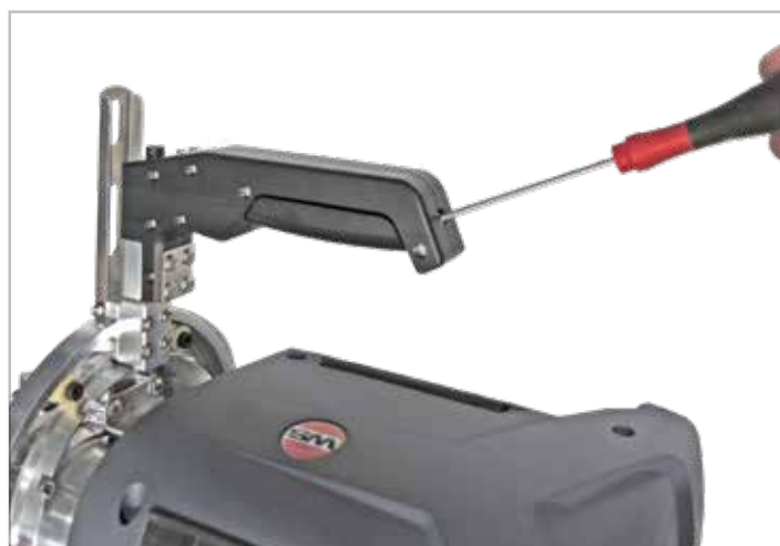
4. Abdeckung am Batteriefach wieder einsetzen und Handgriff verschrauben.
