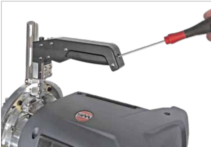
1. Am Handgriff Hinten, die Schraube herausdrehen.
